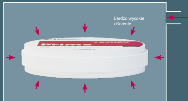
Prasowanie izostatyczne na zimno (CIP)
