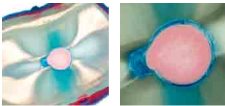
Tradycyjny uszczelniacz Y (penetracja barwnika) Commercially available sealer Y (dye penetration)
