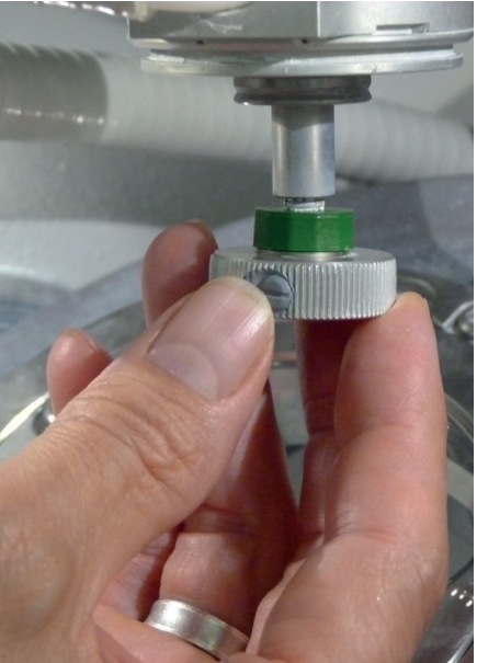
Zdj. 4: Dokręcenie chwytaka w trzpieniu do momentu osiągnięcia zamierzonego momentu obrotowego
