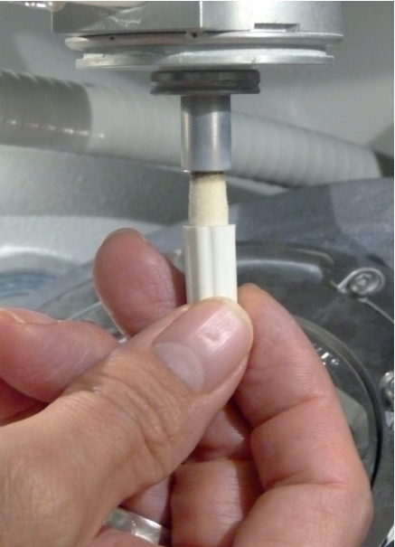
Zdj. 1: Oczyszczanie wewnętrznego stożka wału trzpienia wrzeciona
